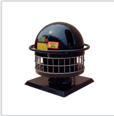
Wentylator przeciwybuchowy DAExC. Typ: DAExC-160, 200, 250, 315, 400, 630. Obroty [obr/min-1]: 700,900,1400. Wydajność [m 3 /h]: 108-29000. Moc [kW]: 0,06-5,5. Napięcie [V]: 3 x 400. Cisnienie akustyczne [dB(A)-(1 m)]: 49-81. Wykonanie: kompozycja antystatyczna. Kolor: czarny. Cena netto [zł]: 3025-33 120.
