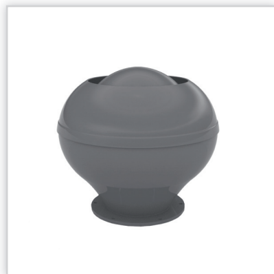
Wywiewnik WLO. Typ: WLO-160, 200, 250, 315, 400, 630, WLO PCV-160, 200, 250, 315. Wykonanie: laminat poliestrowo-szkłany. Maksymalna temperatura [°C]: 700. Kolor: dowolny wg tabeli RAL. Cena netto [zł]: 490-5.870.
