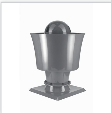
Wywiewnik WZs (standardowy), WZk (kwasoodporny). Typ: WZs(k)-315, 400, 630. Wykonanie: laminat poliestrowo-szkłany. Maksymalna temperatura [°C]: 700. Kolor: dowolny wg tabeli RAL. Cena netto [zł]: 1950-3900.
