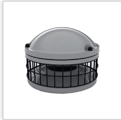
Wentylator dachowy FEN. Typ: FEN-160, 250, 315, 400, 500. Obroty [obr/min-1]: 700, 900. Wydajność [m 3 /h]: 325-7100. Moc [kW]: 0,04/1,6. Napięcie [V]: 1 x 230 lub 3 x 400. Cisnienie akustyczne [dB(A)-(1 m)]: 51-75. Wykonanie: laminat poliestrowo-szkłany. Kolor: dowolny wg tabeli RAL. Cena netto [zł]: 1860-8810.
